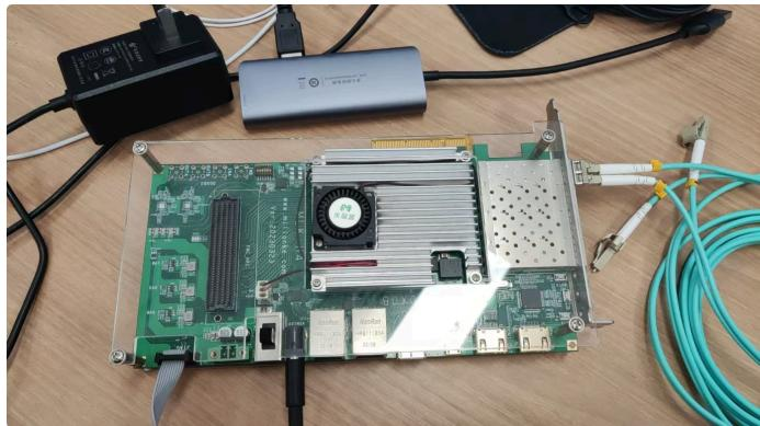
最后，我还是和周老师沟通，发现米客联板子上SFP\_D口的TX引脚的tx\_disable被一个小电阻上拉了，导致光口失能了，把这个管脚下拉就行了。所以说，不能只熟悉软件编写，还得对硬件和板子都很熟悉才能避免这种问题。
